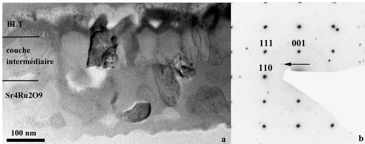
Figure 1 : a) Coupe transversale d'un échantillon de type couche mince élaboré sous une pression d'oxygène de 50 mTorr b) diffraction électronique indexée suivant l'axe de zone [1-10] dans la structure \text{SrTiO}_3 (flèche indique tâche de surstructure)
